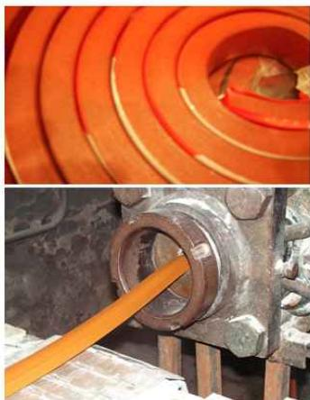
ГИДРОФЕСТ – гидроизоляционная прокладка, на основе бутилкаучука и модифицированной бентонитовой глины.
