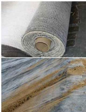
ВОДОУПОР® – рулонный геотекстильный материал, состоящий из двух слоев синтетического полотна, между которыми расположен и закреплен иглопробивным способом слой гранулированной модифицированной бентонитовой глины.
