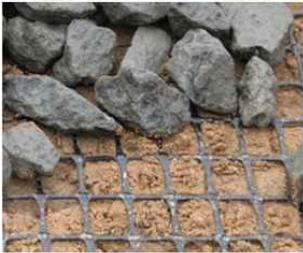
Двухосная георешетка - это плоский полимерный материал сетчатой структуры с жесткими узловыми соединениями, образующими ячейки. Двухосная георешетка производится методом экструзии с последующей ориентацией в продольном и поперечном направлении.
