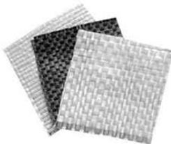
Тканый геотекстиль изготавливается путем переплетения полипропиленовых нитей под углом 90°. Плотность материала зависит от плотности переплетения и толщины нити и может достигать от 70 до 500 г/м<sup>2</sup>.
